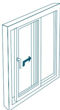
**SISTEMAS DE APERTURA** Apertura elevadora con cierre térmico mediante selladores.
